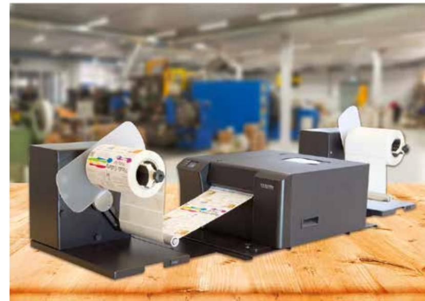
El enrollador RW-7 y el desenrollador UW-7 son compatibles con tres diámetros de núcleo: 25,4 mm, 50,8 mm y 76,2 mm, ofreciendo la flexibilidad para producir rollos de etiquetas que se ajusten a los requisitos de la máquina de acabado que utilizará después. La capacidad máxima de rebobinado es de 152,4 mm con un ancho máximo de rollo de 177,8 mm y además la velocidad de enrollado máxima es de hasta 348 mm por segundo. Las etique-
