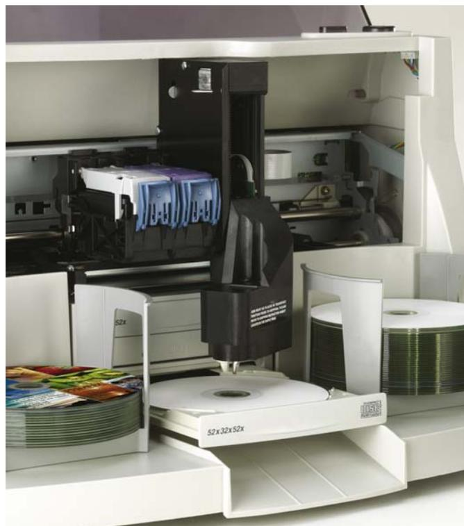
Der Laufwerksschlitten des unteren Brenners fährt aus und der Roboterarm des Publishers greift das Speichermedium sicher heraus und führt es zum Bedrucken
