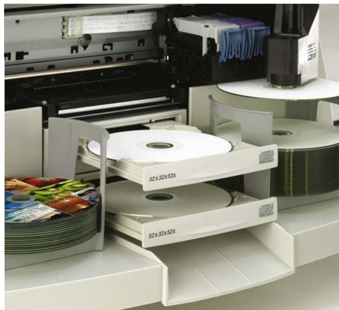
Alles in Aktion. Zwei Behälter für Medien sind links und rechts von den beiden Brennern angebracht. Sie können jeweils maximal 50 Rohlinge aufnehmen, die dann verarbeitet werden
