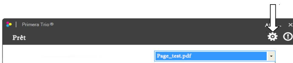
2. La fenêtre des paramètres du Scanner s'ouvrira. Cliquez sur Calibrer ou Nettoyer le scanner. Vous serez amenés à insérer le papier de nettoyage ou de calibration.
