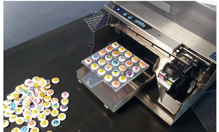
Durch die Verwendung der speziellen Einsätze ist das Bedrucken mehrerer Produkte in einem Durchgang (z. B. bis zu fünf Macarons oder 64 Schokolinsen) einfach, präzise und je nach Artikel sogar schneller möglich. DTM Print bietet zudem den Service an, Einsätze gemäß Kundenspezifikationen zu produzieren.
