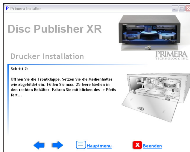
Bild 1. Schnelle Einrichtung durch weitgehende Unterstützung: Beim Aufbau des CD/DVD-Duplizier- und Drucksystems wird der Anwender vom Einrichtungsassistenten unterstützt, der den Aufbau des Geräts zeigt.
