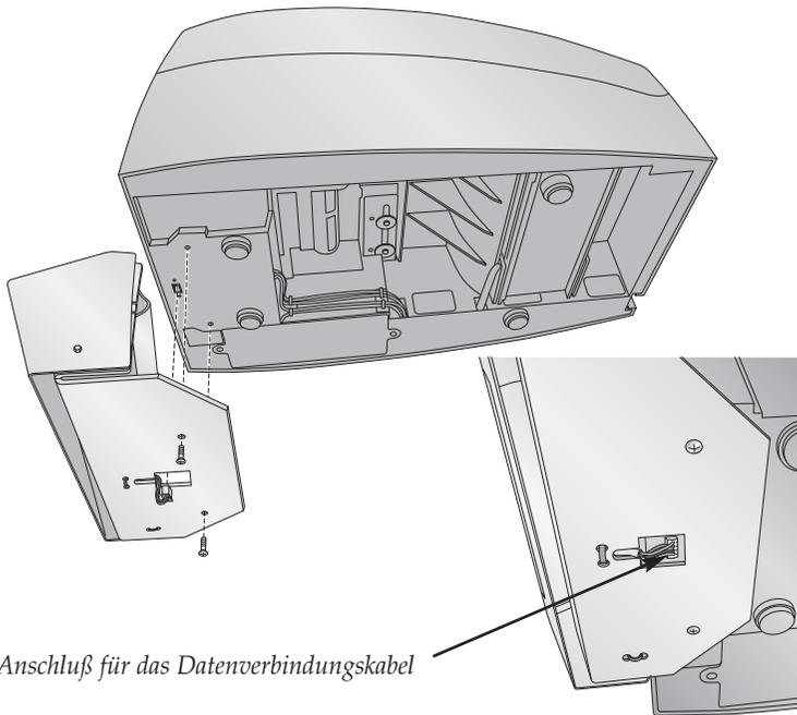
Anschluß für das Datenverbindungskabel
